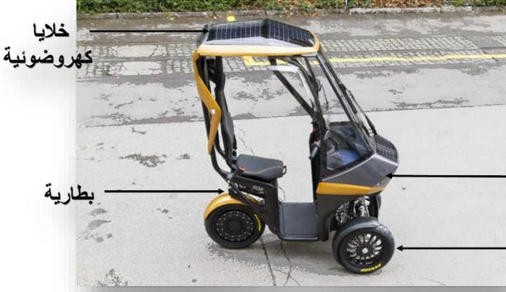
تعتبر الطاقات المتجددة البديل الأمثل للطاقات الناتجة عن احتراق الفحم الهيدروجينية والفحم ومن أهمها الطاقة الشمسية، تمثل الوثيقة المقابلة دراجة كهربائية صديقة للبيئة، في النهار الخلايا الكهروضوئية تغذي المحرك وت شحن بطارية في نفس الوقت.
