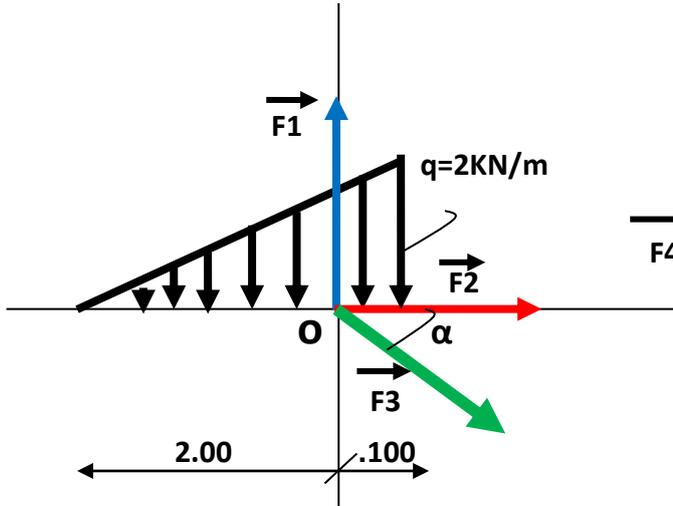
اليك الشكل المقابل حيث:  $F_1 = 10 \text{ KN}$   $F_2 = 1.536 \text{ KN}$
