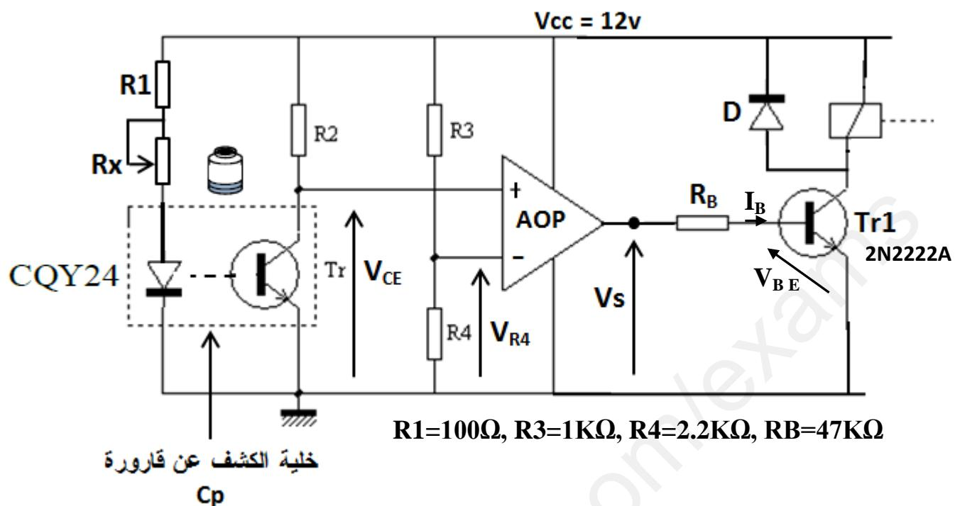
• طابق التضخيم لدارة التنبيه : عند غلق 50 قارورة يكشف عنه كاشف p فيسبب تشغيل منه صوتي لتنبيه العامل بضرورة ملء قناة المغاليق قبل فراغها، لتوفير الاستطاعة الكافية للمنبه استعملنا التركيب التالي :
