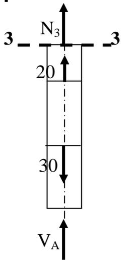
$\sigma_3 = \frac{N_3}{S} = \frac{-10 \times 10^3}{200} = -50Mpa$ <p>ملاحظة: لكل مقطع : (0.25) لحساب الجهد و(0.25) لحساب الإجهاد و(0.25) لرسم المقطع</p> |      |
