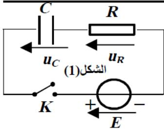
نربط على التسلسل العناصر الكهربائية التالية: ناقل أومي مقاومته  $R$  ، مكثفة غير مشحونة سعتها  $C$  ، مولد ذو توتر ثابت  $E = 12 V$  ، قاطعة  $K$  - الشكل (1) -
