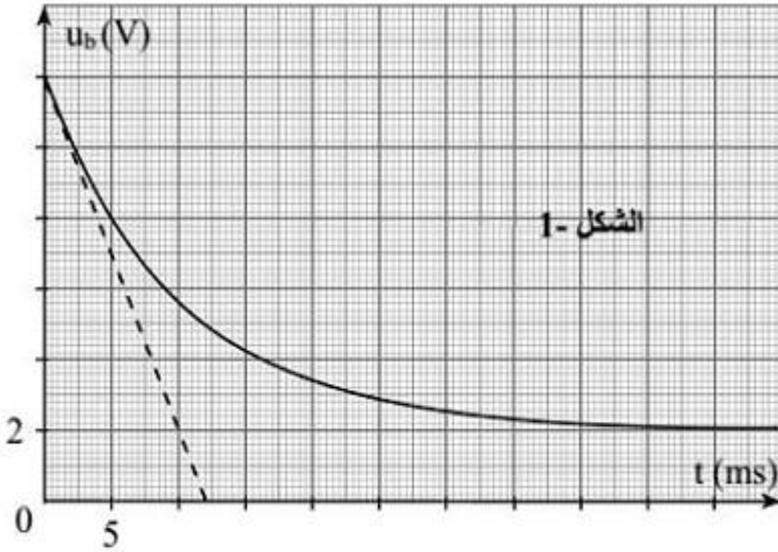
تتكون دارة كهربائية على التسلسل من مولد للتوتر قوته المحركة الكهربائية  $E$  ، وشيعة ذاتيتها  $L$  ومقاومتها الداخلية  $r$  ، ناقل أومي مقاومته:  $R = 100 \Omega$  ، قاطعة  $K$  .
