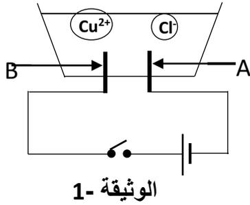
يستخدم غاز الكلور في صناعة المواد الكيميائية خصوصا مواد التنظيف من بينها الجافيل ونظرا لأهميته، اقترح الأستاذ على تلاميذه البروتوكول التجريبي الموضح بالوثيقة 1 ، من اجل تحضير هذا الغاز .
